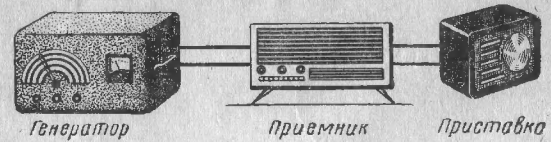
Рис. 10. Настройка приставки со звуковым генератором
